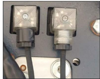
12/24 V magnetventil; DIN 43650 (IP klass 65), med LED indikator; transparentt hus.
