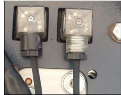
12/24 V magnetventil; DIN 43650 (IP klass 65), med LED indikator; transparentt hus.
